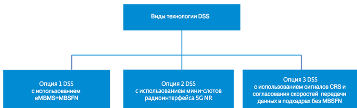
Рисунок 1.2 – Три основных типа технологии DSS: eMBMS+MBSFN, мини-слоты 5G NR и конфигурация на основе CRS
